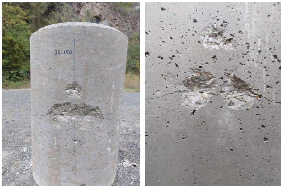
Slika 8-7. Učinak naboja koristeći raspored 75 mm x 150 mm
