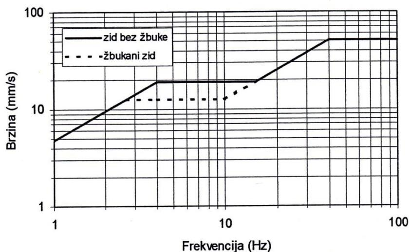
**Slika 3-2.** Dijagram granica brzina oscilacija tla za različite tipove konstrukcija u funkciji frekvencije (definirano normom USBM RI8507 And OSMRE) (Stanković, 2011)
