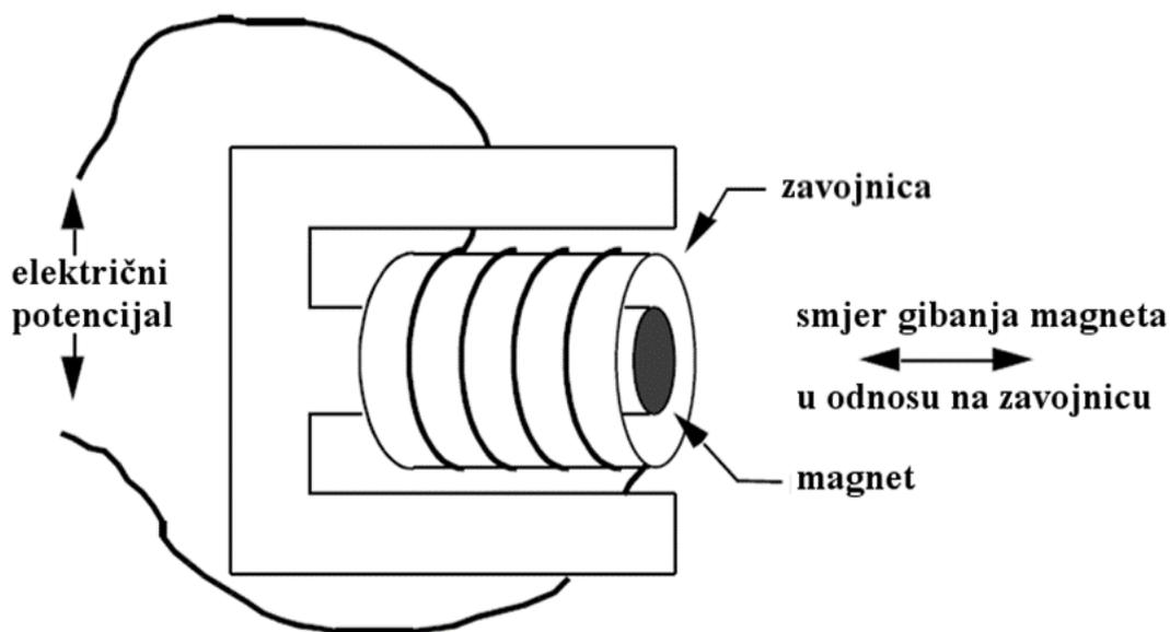
Slika 2-2. Načina rada geofona – (BlastMate III Operator Manual 2001.)
