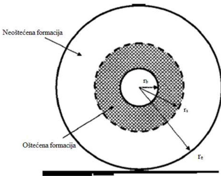
**Slika 2-1.** Shematski prikaz oštećene pribušotinske zone (Civan, 2007)
