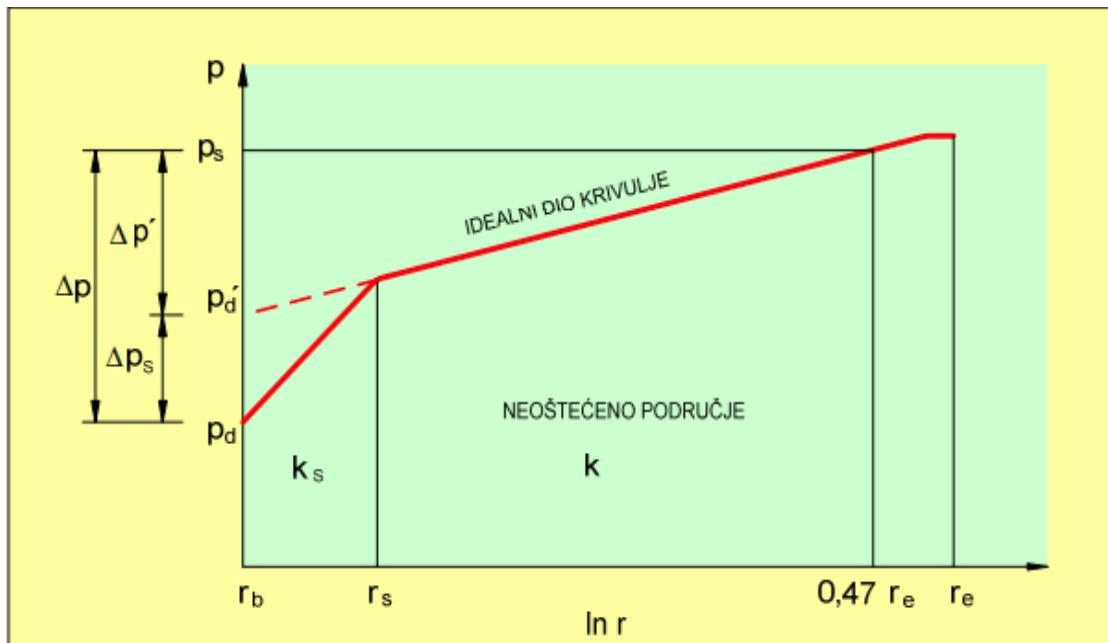
**Slika 2-2.** Krivulje raspodjele tlakova u stijenama uokolo kanala bušotine, prilikom proizvodnje iz oštećenog i neoštećenog ležišta (Gaurina-Međimurec, 2004)
