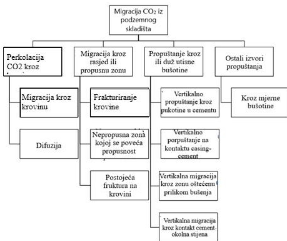
Slika 6-4. Prikaz potencijalnih puteva migracije CO 2 iz podzemnog skladišta (Oraee-Mirzamani et al., 2013)
