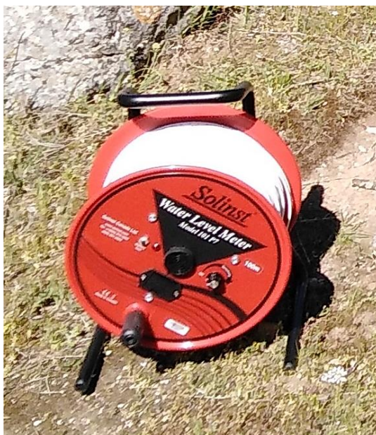
Slika 4-2. Ručni mjerač razine podzemne vode
