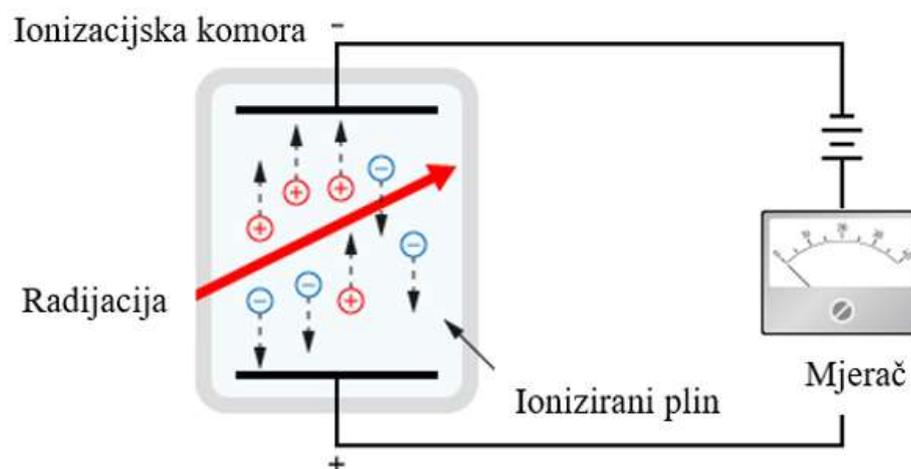
Slika 3-3 Ionizacijska komora (Matsusada precision Inc., 2022)
