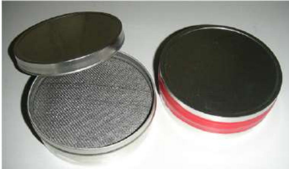
Slika 3-5 Prikaz zatvorenog spremnika sa zaštitom trakom na poklopcu (desno) i otvorenog spremnika s mrežicom za smještaj posteljice (lijevo) (Darwish Al-Azmi et al., 2012)
