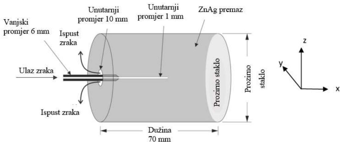
Slika 3-1 Shematski prikaz scintilacijske ćelije (Agrwal et al., 2022)
