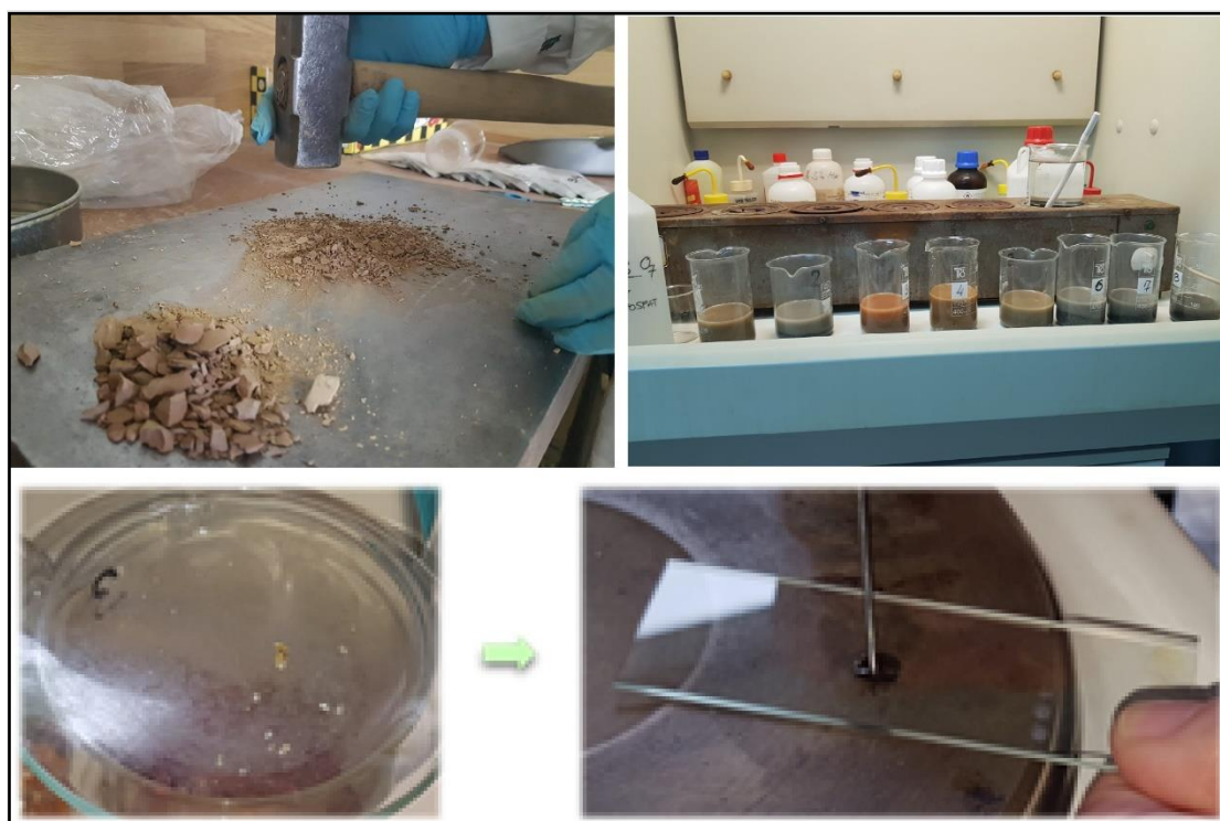
Slika 21. Proces pripreme uzoraka za palinološke analize (A. Čaić)
