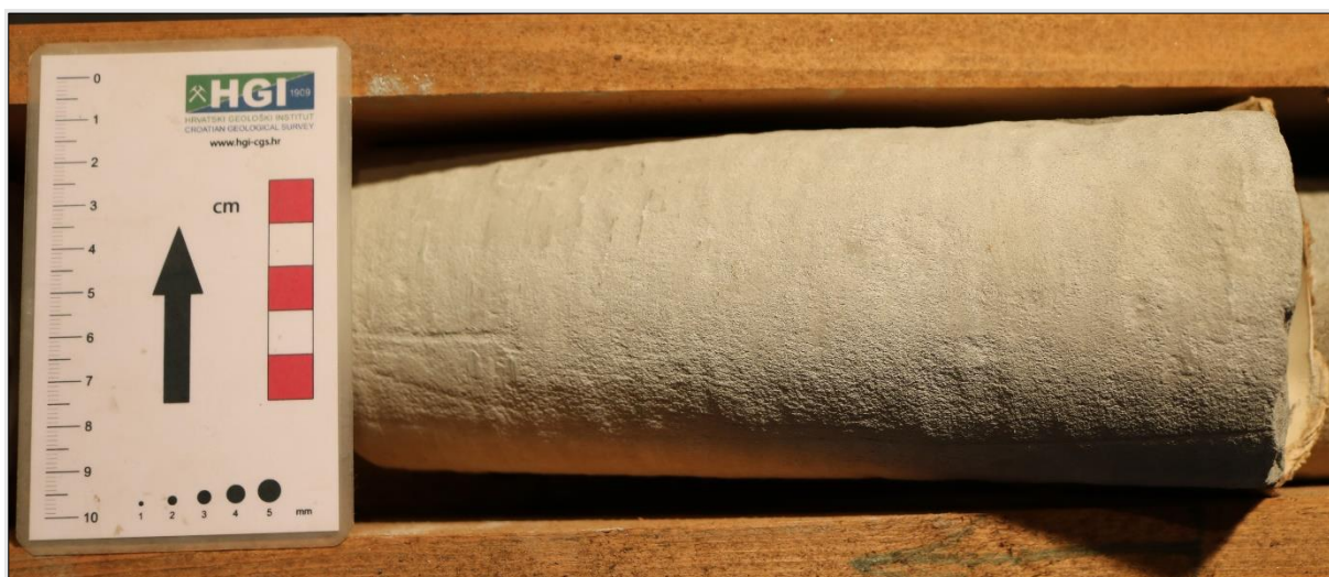
Slika 37. Izgled jezgre masivnog sitnozrnatog i srednjezrnatog pješčenjaka.
