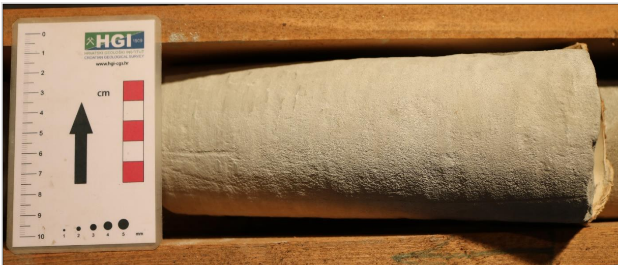
Slika 37. Izgled jezgre masivnog sitnozrnatog i srednjezrnatog pješčenjaka.
