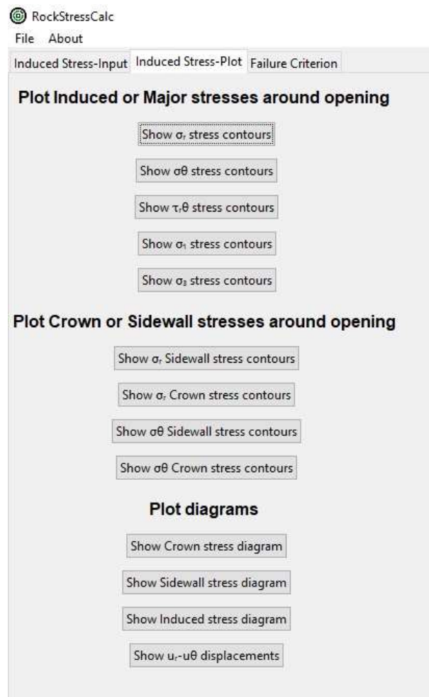
Slika 5-4. Mogućnosti prikaza sekundarnih naprezanja i pomaka
