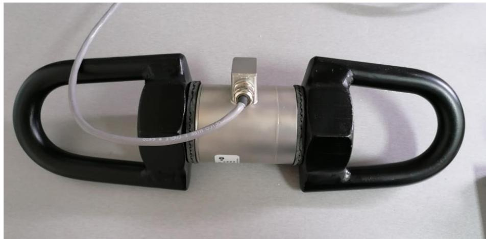
*Slika 4.5. Dinamometar*
