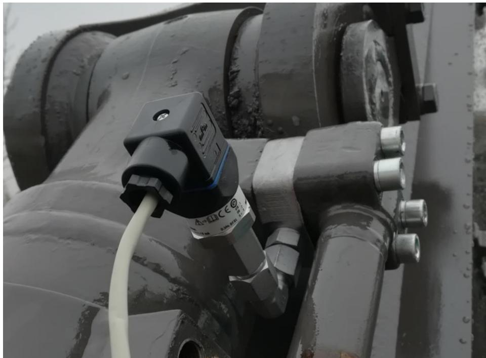
Slika 4.3. Spajanje mjernoga pretvornika tlaka (Klanfar i sur., 2018)
