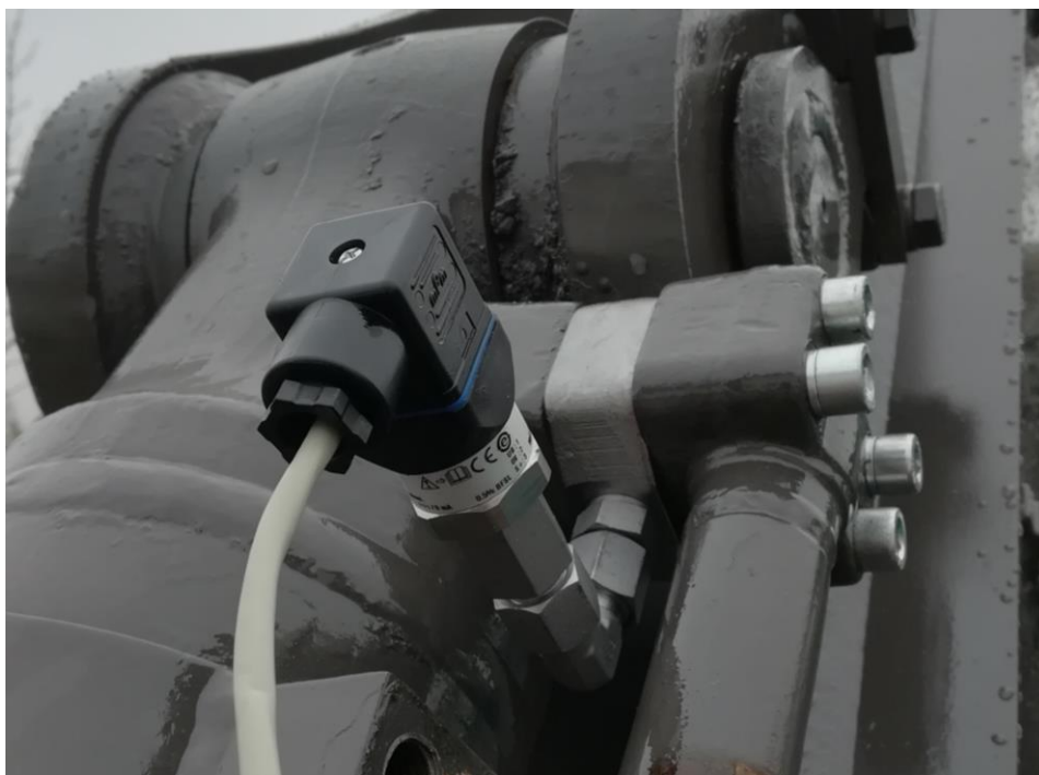
Slika 4.3. Spajanje mjernoga pretvornika tlaka (Klanfar i sur., 2018)
