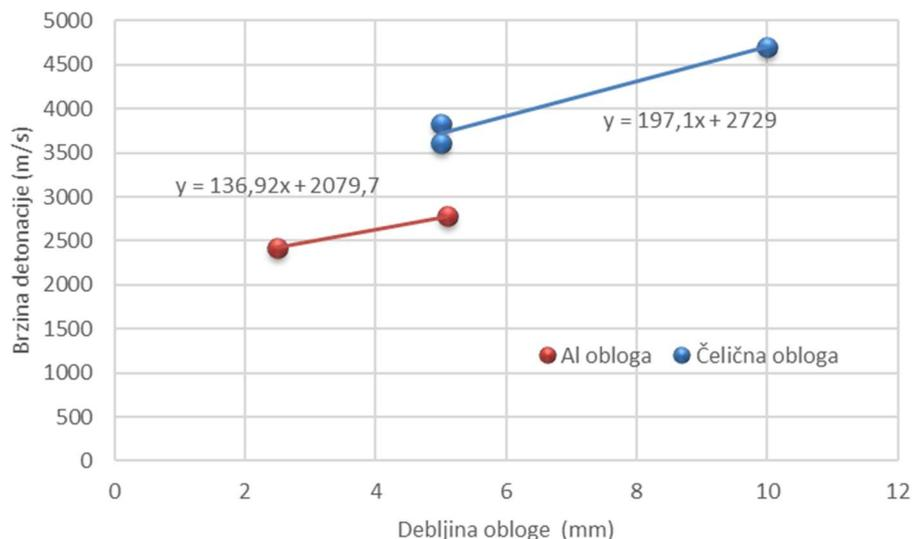
Slika 5-1. Utjecaj debljine obloge na izmjerenu brzinu detonacije ANFO eksploziva
