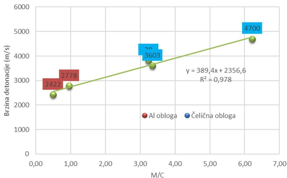
Slika 5-2. Utjecaj M/C na izmjerenu brzinu detonacije ANFO eksploziva
