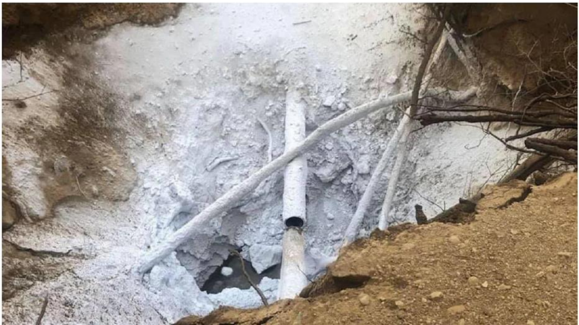
Slika 5-4. Istjecanje CO 2 uslijed puknuća cjevovoda i smrzavanje uzrokovano Joule Thomson-ovim efektom (Capello et al., 2022)
