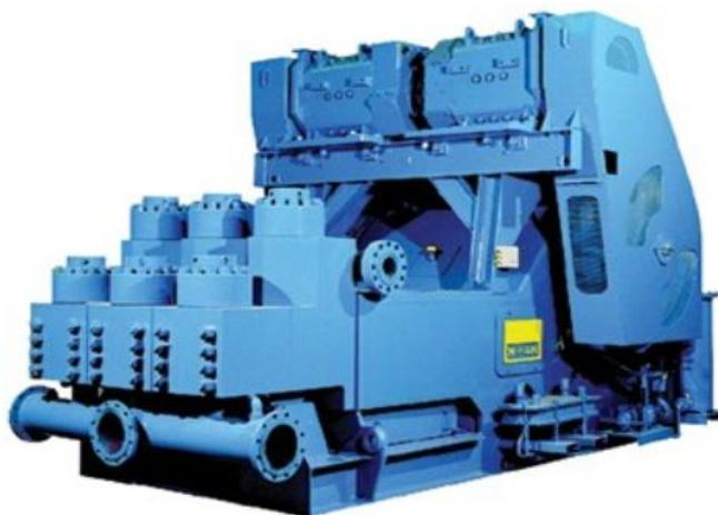
**Slika 7-1.** Trocilindrična jednoradna isplačna pumpa (Bejger i Piasecki, 2013)
