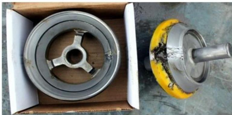
**Slika7-2.** Oštećenje sjedišta ventila pumpe (Bejger i Piasecki, 2013)
