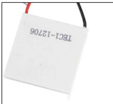
Slika 4-2. Termoelektrični generator peltier (Robocraze, 2021)
