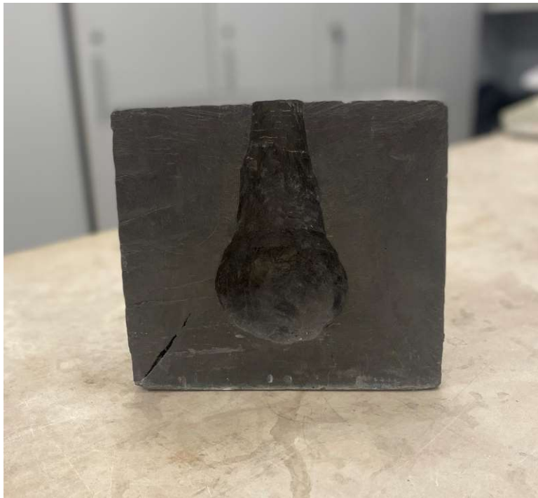
Slika 4-3. Presjek olovnoga bloka nakon detonacije.
