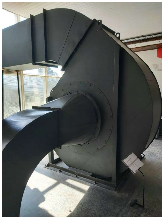
Slika 1-3. Centrifugalni ventilator NVLR-12 u Tehničkom muzeju Nikola Tesla
