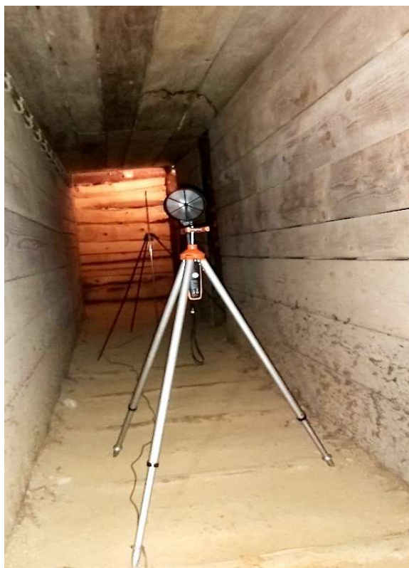
Slika 2-7. Krilna sonda i Pittotova cijev na stalcima
