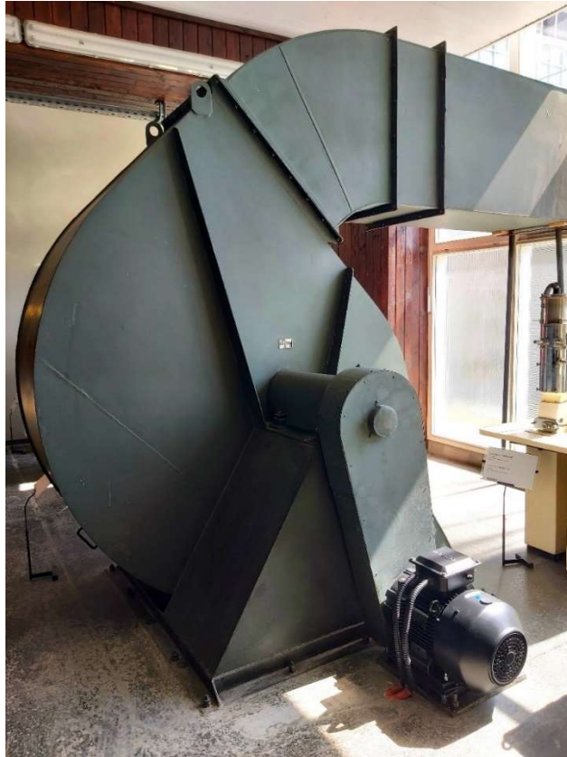
Slika 1-2. Centrifugalni ventilator NVLR-12 u Tehničkom muzeju Nikola Tesla
