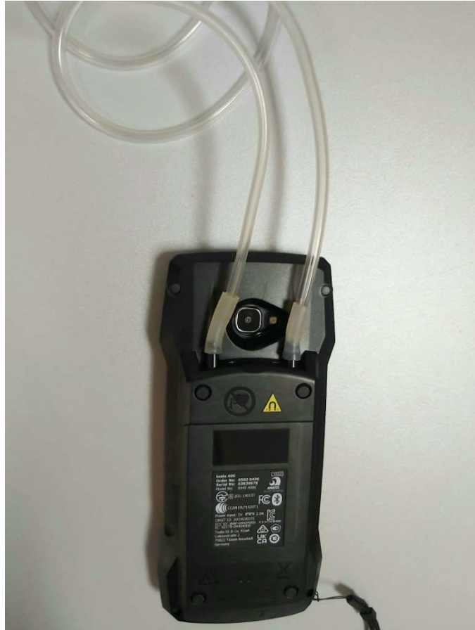
Slika 2-5. Multifunkcijski mjerni uređaj TESTO 400 spojen cjevčicama sa Pittotovim cijevima
