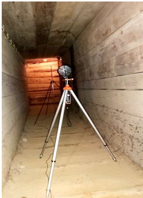
Slika 2-7. Krilna sonda i Pittotova cijev na stalcima
