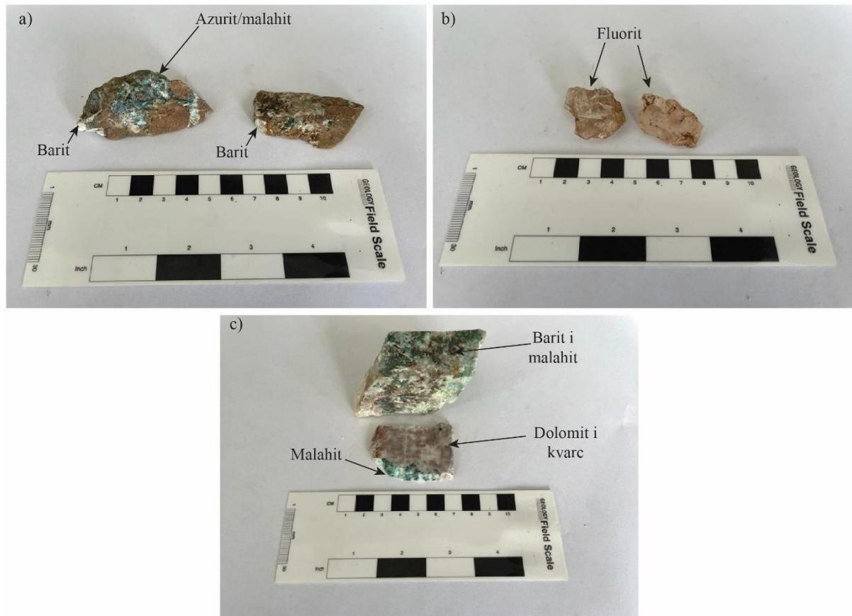
**Slika 7-3.** Makrofotografije mineralizacije unutar dolomita Meovršja. a) Uzorak M 1/2 s izraženom limonitizacijom smećkaste boje, bijeli barit, modri azurit te zelenkasti malahit. Na dijelovima uzorka postoje i manje pojave fluorita; b) fragmenti čistog, prozirnog fluorita i c) pojave baritno-azuritno-malahitnih mineralizacija unutar sivog dolomita
