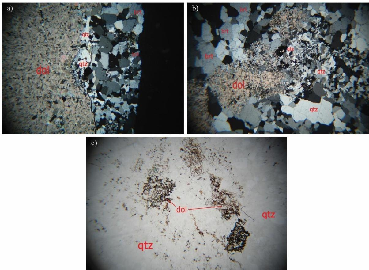
**Slika 7-2.** Mikrofotografije uzoraka M 1 i M 2/3. a) Kontakt dolomita s kvarcom. Vidljivo je smanjenje zrna dolomita kako idu prema kvarcu; b) ostaci primarnog dolomita okruženog s mineralizacijom u obliku kvarca i barita i c) trošni dolomit okružen kvarcom
