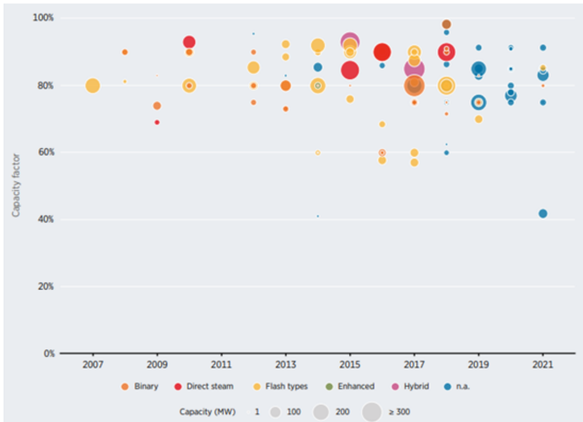
Slika 3-4. Faktori kapaciteta geotermalnih elektrana prema tehnologiji i veličini projekata, 2007.-2021 (IRENA, 2022b)
