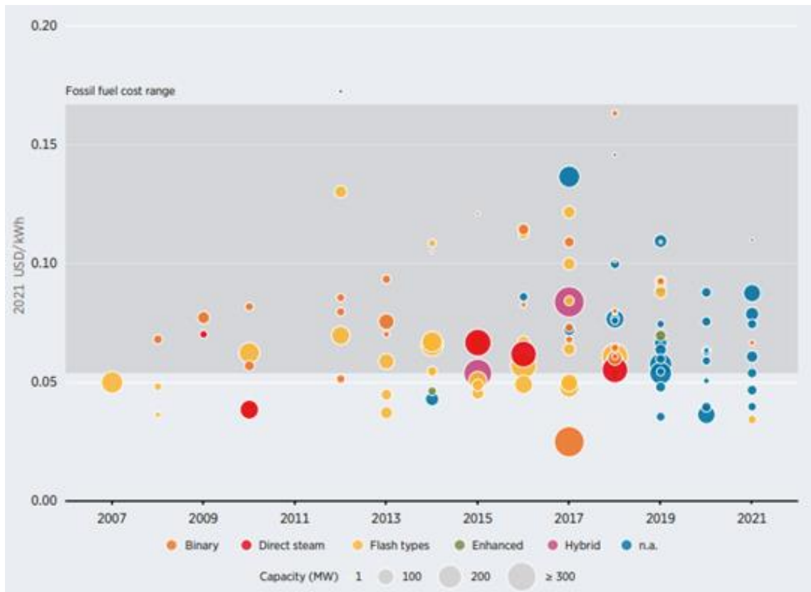
Slika 3-5. LCOE geotermalnih energetske projekata po tehnologiji i veličini projekata (IRENA 2022b)
