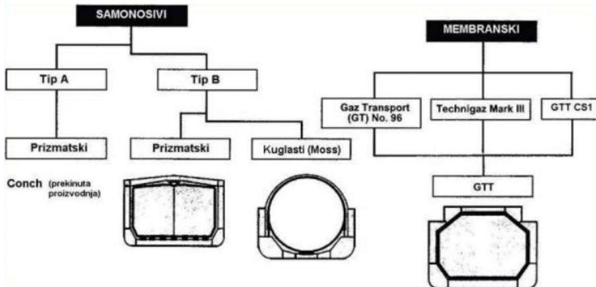
Slika 4-1. Podjela spremnika na brodovima za prijevoz LNG-a (Posavec et al., 2010)
