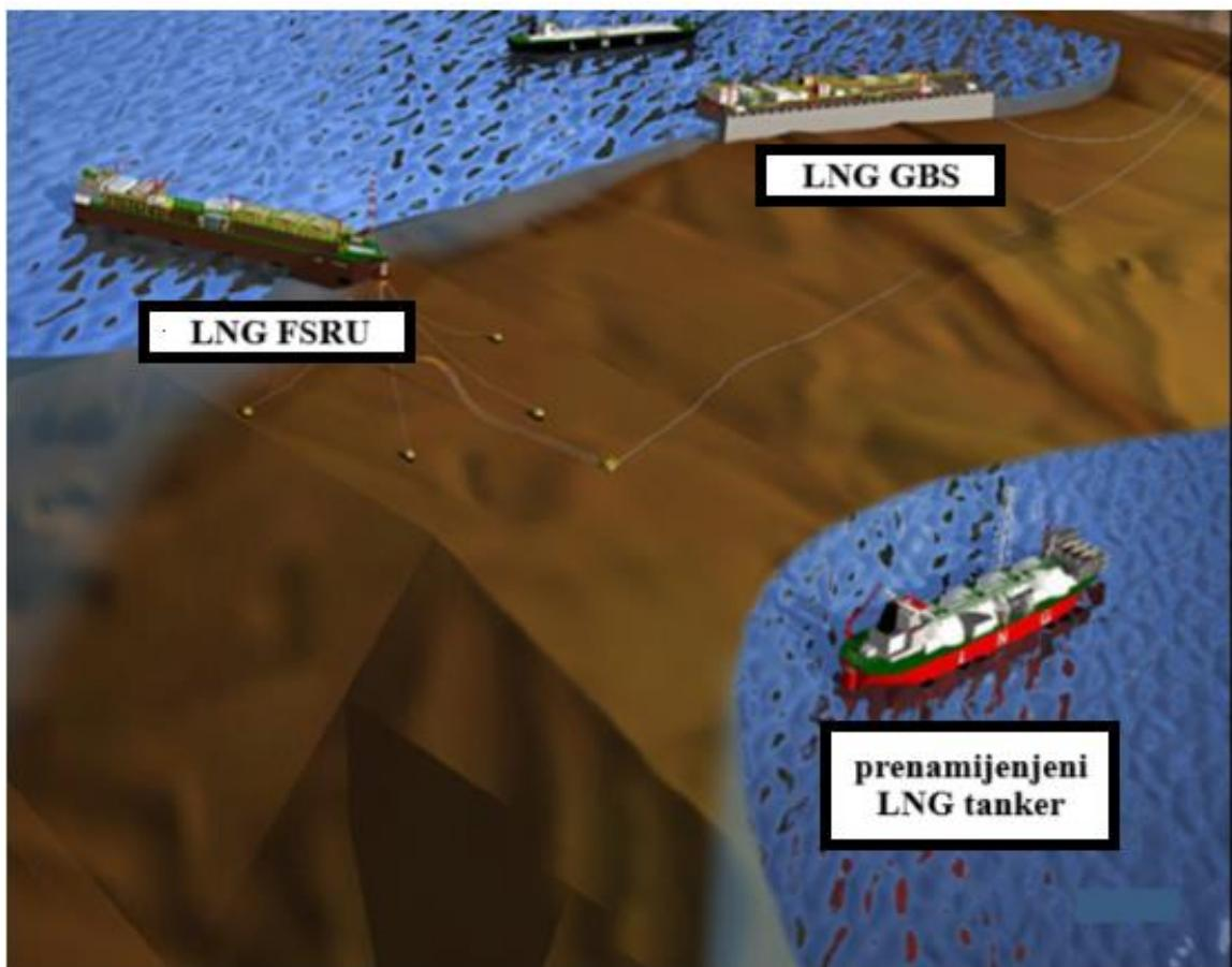
**Slika 2-4.** Tipovi odobalnih LNG terminala za uplinjavanje (Simon, 2023)
