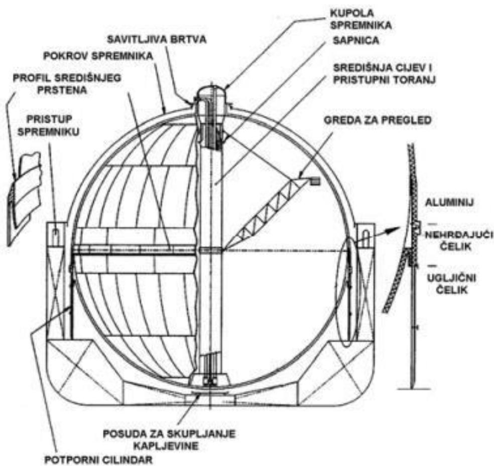
Slika 4-6. Kuglasti (Mossov) spremnik (Posavec et al., 2010)
