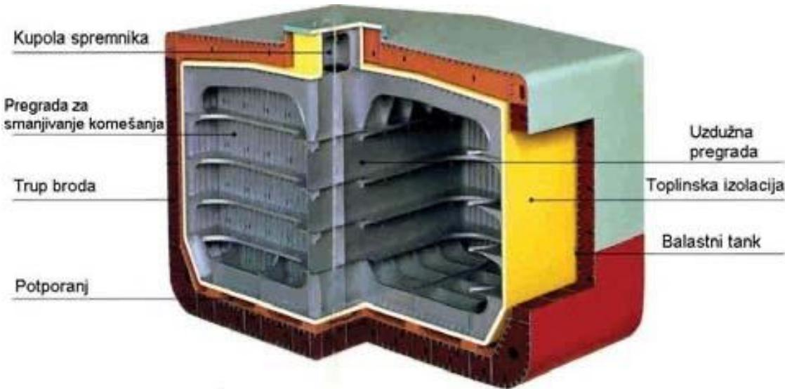
**Slika 4-3.** Prikaz unutrašnjosti prizmatskog spremnika (Posavec et al., 2010)
