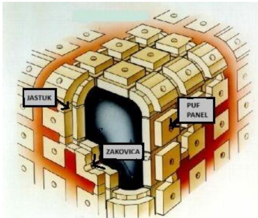
Slika 4-2. Izolacija SPB spremnika (SPB Technology, n.d.)
