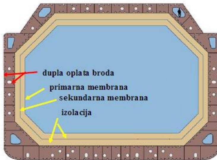
Slika 4-8. Poprečni presjek membranskog spremnika (Simon, 2023)
