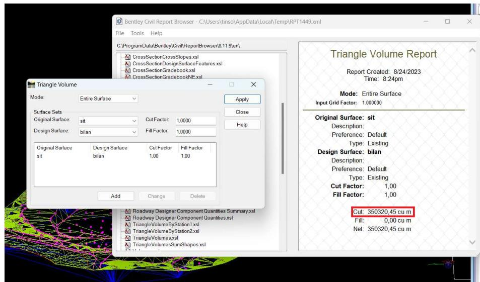
Slika 6-5 Prikaz izlaznog rezultata, obujma za proračun bilančnih rezervi, MRM metodom
