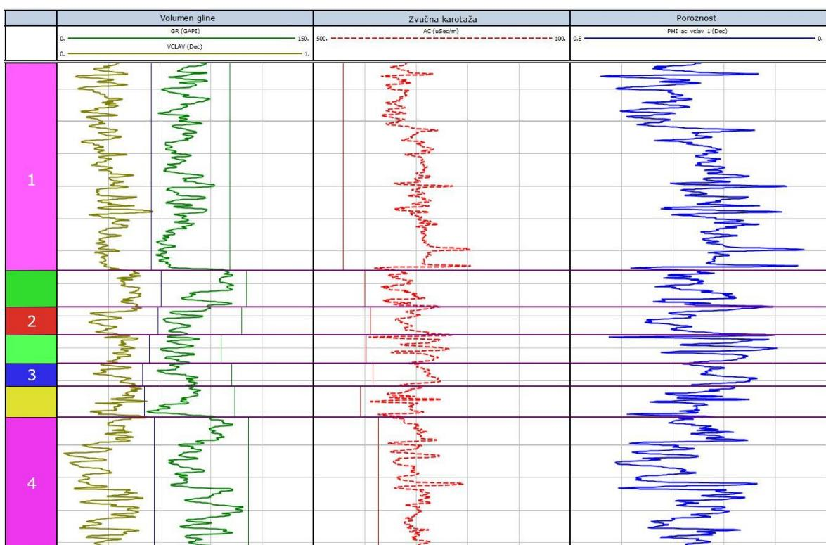
**Slika 4-5** Redom prikazane krivulje su krivulja gama-karotaže, krivulja volumena gline, krivulja zvučne karotaže i krivulja izračunate poroznosti za buštinu A
