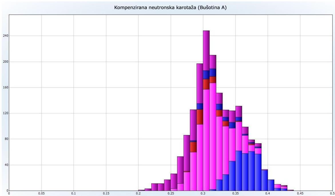
**Slika 4-9** Histogram vrijednosti kompenzirane neutronske karotažom za buštinu A.
