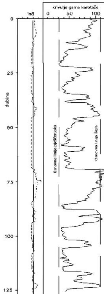
**Slika 3-2** Primjer krivulje gama-karotaže koja prati trend povećanih vrijednosti u niskopropusnim naslagama, a smanjenih vrijednosti u visokopropusnim (preuređeno iz Rider, 2002)
