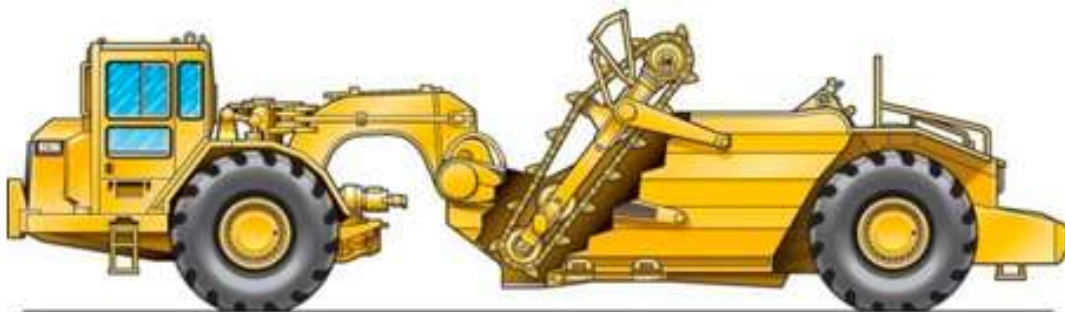
Slika 3-4. Skreper s elevatorom
