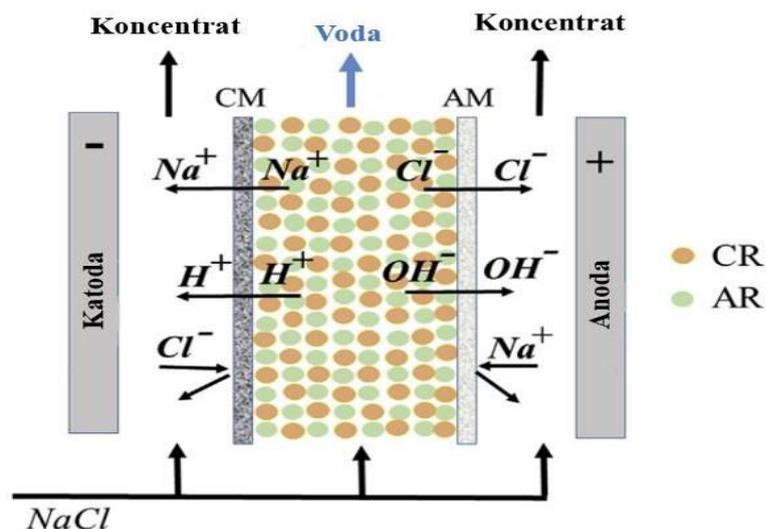
**Slika 2-5.** Princip rada jedinice za elektrodeionizaciju. AM, anionsko-izmjenjivačka membrana; AR, anionska smola; CM, kationska izmjenjivačka membrana; CR, kationska smola. (Sillanpää i Shestakova, 2017.)
