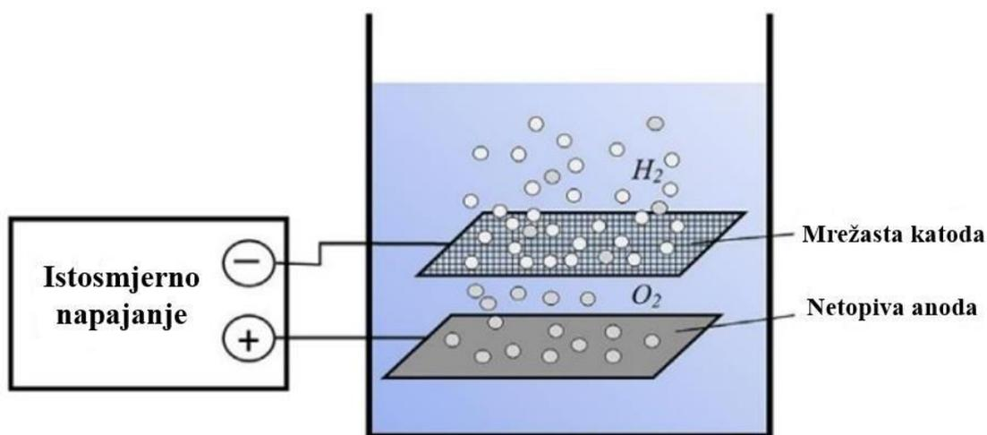
**Slika 2-3.** Shematski dijagram procesa elektroflotacije (Sillanpää i Shestakova, 2017.)
