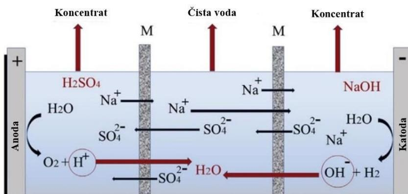
**Slika 2-4.** Shematski prikaz jednostavnog elektrodijalizatora s neaktivnim poroznim membranama (Sillanpää i Shestakova, 2017.)
