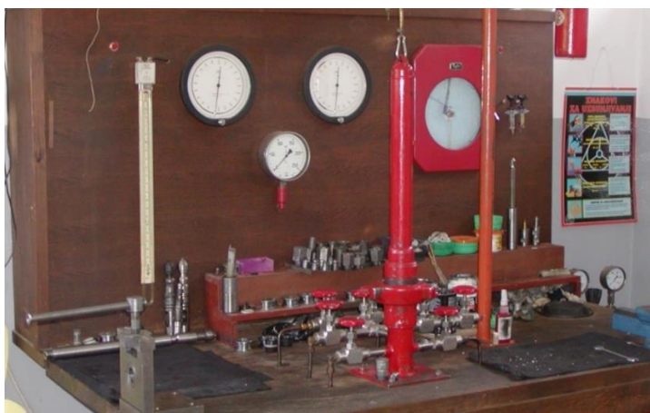
Slika 5-1. Radionica za podešavanje plinskih ventila Šandrovac (Brkić, 2022)
