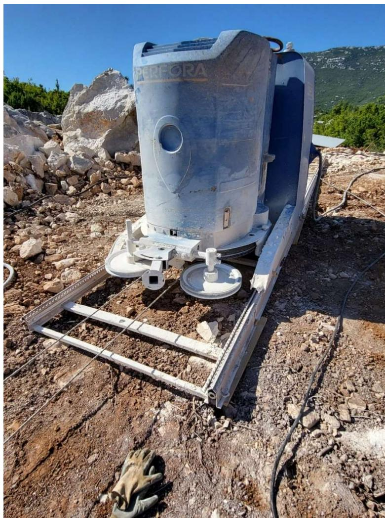
**Slika 2-1.** Dijamantna žična pila marke Perfora.
