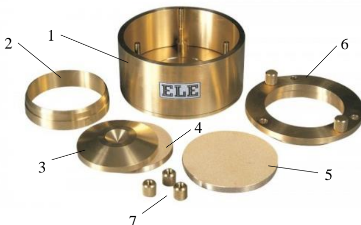
Slika 4-3. Edometarska ćelija za uzorak (izvor: https://www.ele.com/ )
