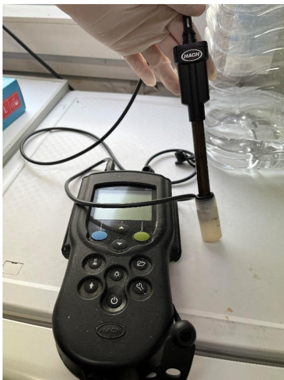
Slika 7-3. Hach HQ40D uređaj sa sondama za mjerenje pH vrijednosti i koncentracije otopljenog kisika
