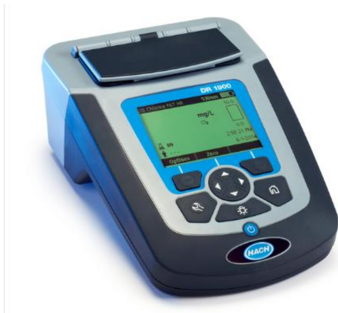
Slika 7-4. Hach DR1900 spektrofotometar
