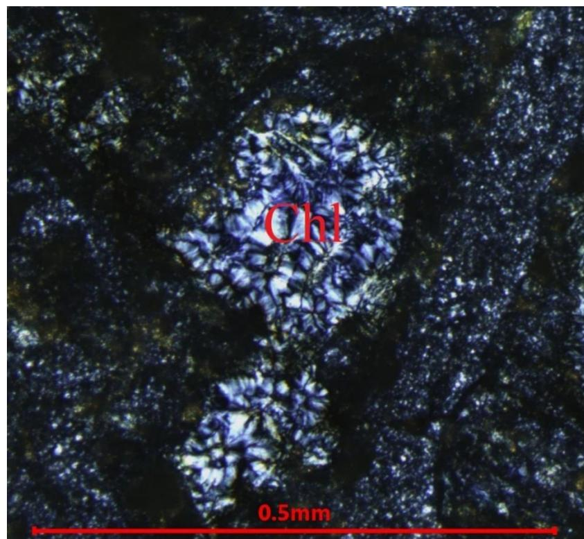
**Slika 4-20.** Mikrofotografija mandula u spilitu, ispunjenim sekundarnim kloritom (uzorak B – 5/23, kamenolom Bojna). Chl-klorit.
