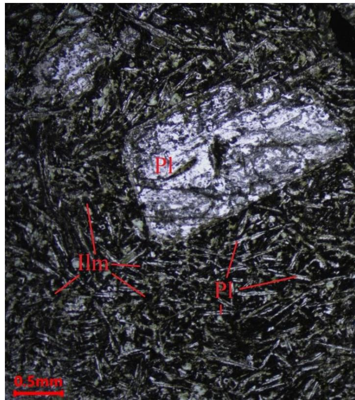
Slika 4-27. Mikrofotografija spilita (uzorak B – 8/23, kamenolom Bojna) s fenokristalom alteriranog plagioklasa u matriksu sa štapićastim plagioklasom i prutićima Cpx i crnim staklom. Pl-plagioklas; Ilm-ilmenit.
