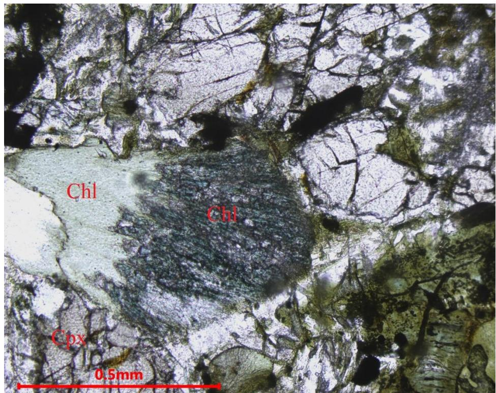
**Slika 4-17.** Mikrofotografija dijabaza, sa šupljinom ispunjenom sa dviće generacije klorita, zelenom i sivom (uzorak B – 4/23, kamenolom Bojna). Chl-klorit; Cpx-klinopiroksen.
