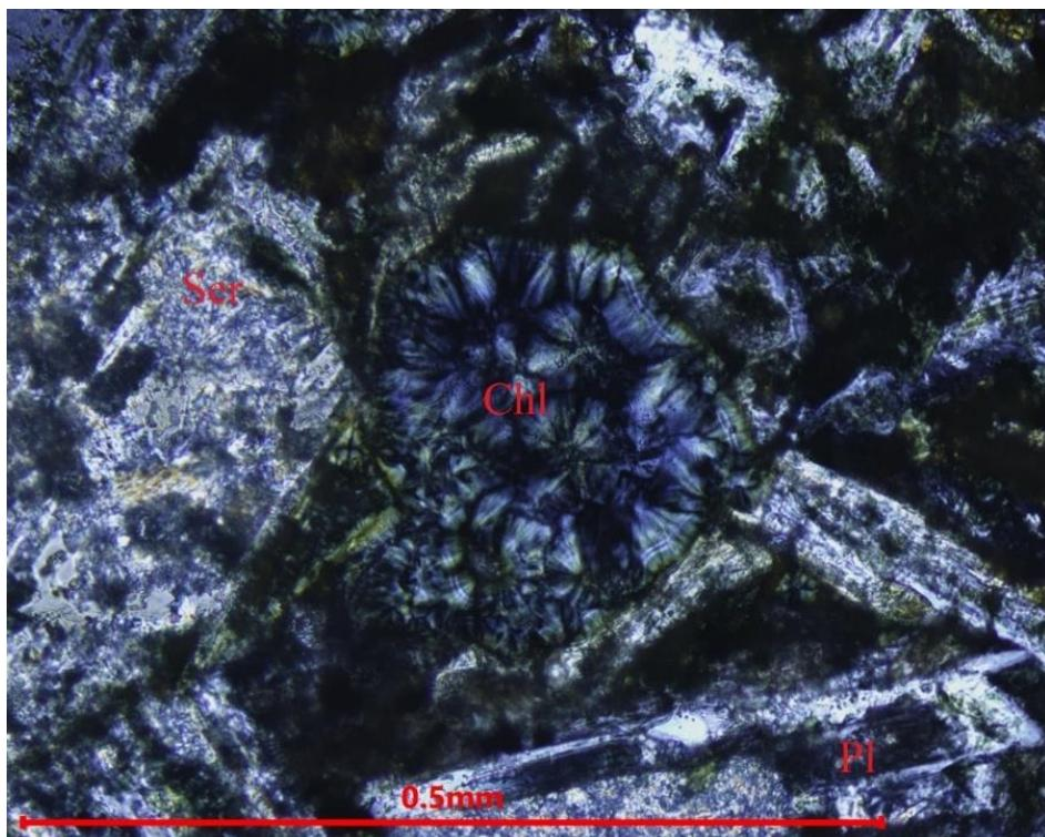
**Slika 4-29.** Mikrofotografija spilita s mandulom ispunjenom kloritom s interferencijskom boje lavande. (uzorak B – 8/23, kamenolom Bojna). Chl-klorit; Pl-plagioklas; Ser-sericit.
