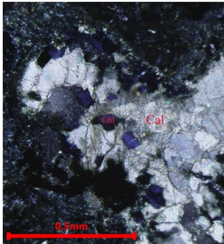
Slika 4-11. Mikrofotografija nepravilnih šupljina ispunjenih sekundarnim kloritom i kalcitom, u spilitu (uzorak B – 2/23, kamenolom Bojna). Cal-kalcit; Chl-klorit.
