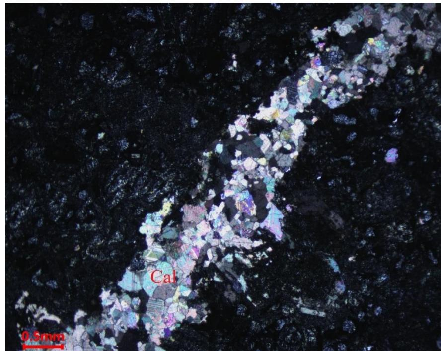
**Slika 4-19.** Mikrofotografija žile u spilitu ispunjenom kalcitom (uzorak B – 5/23, kamenolom Bojna). Cal-kalcit.
