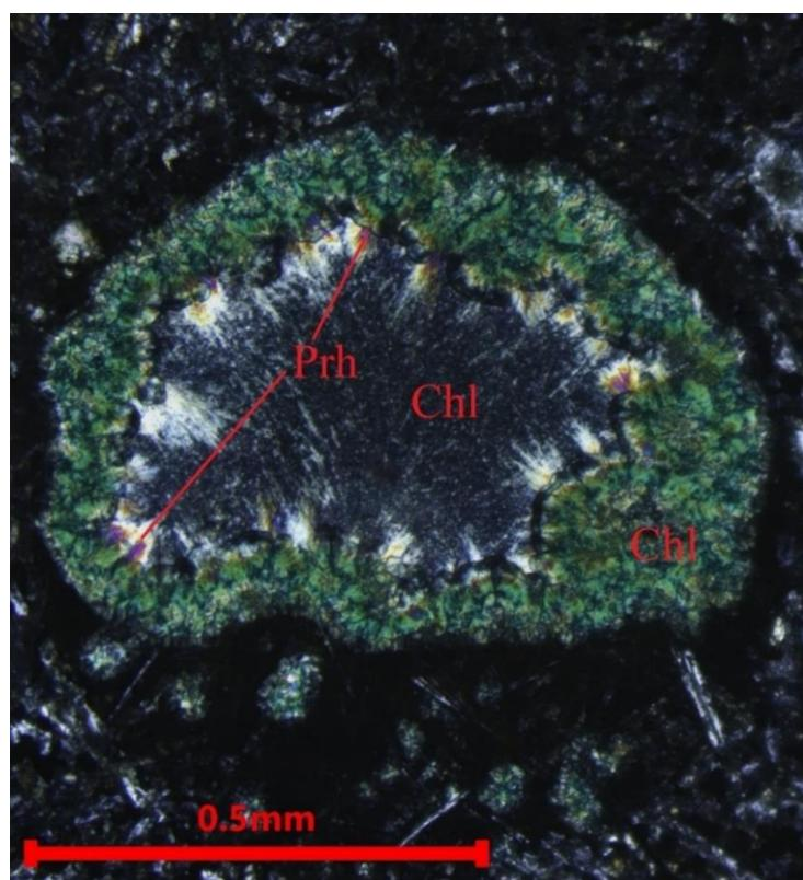
Slika 4-12. Mikrofotografija mandule ispunjene s dviјe vrste klorita (sivi i zeleni) te prehnitom u spilitu (uzorak B – 2/23, kamenolom Bojna). Chl-klorit; Prh-prehnit.
