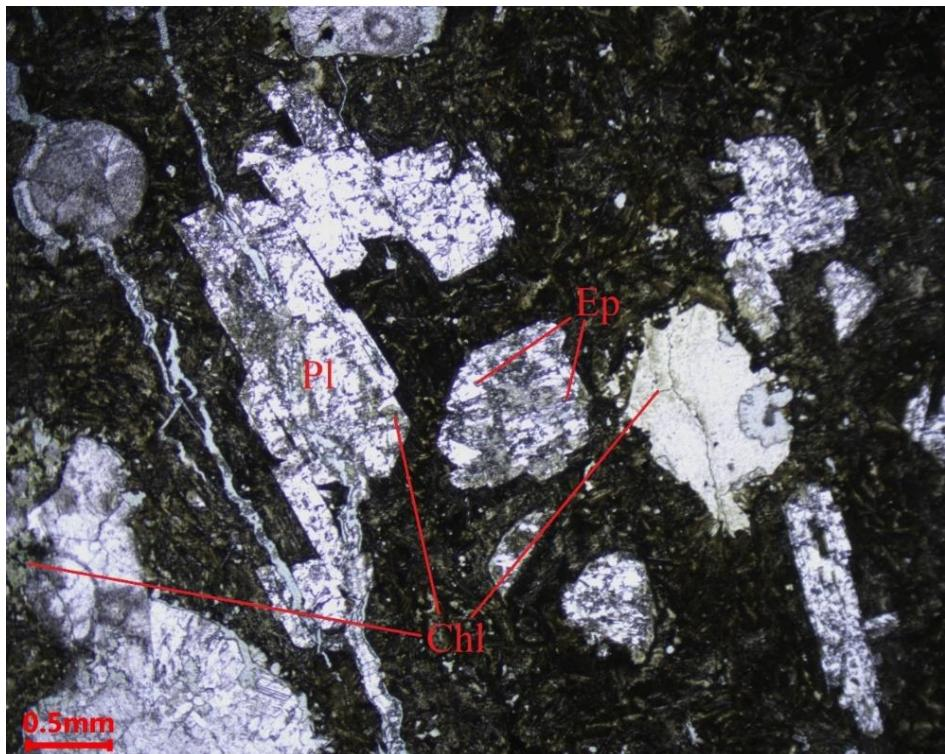
Slika 4-23. Mikrofotografija keratofira s fenokristalima plagioklasa dijelom izmijenjenih u klorit i epidot (uzorak B – 7/23, kamenolom Bojna). Chl-klorit; Pl-plagioklas; Ep-epidot.
