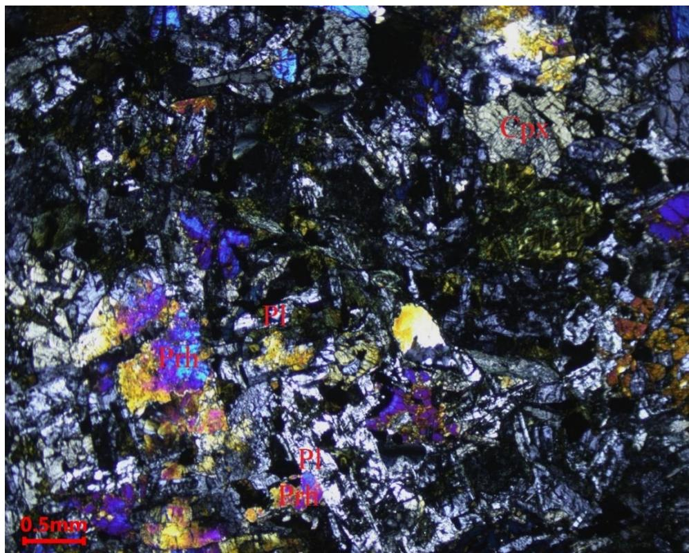
**Slika 4-16.** Mikrofotografija dijabaza (uzorak B – 4/23, kamenolom Bojna) u kojem je plagioklas intenzivno izmijenjen u prehnit, a između štapića plagioklasa su vidljiva sitna zrna klinopiroksena. Cpx-klinopiroksen; Pl-plagioklas; Prh-prehnit.
