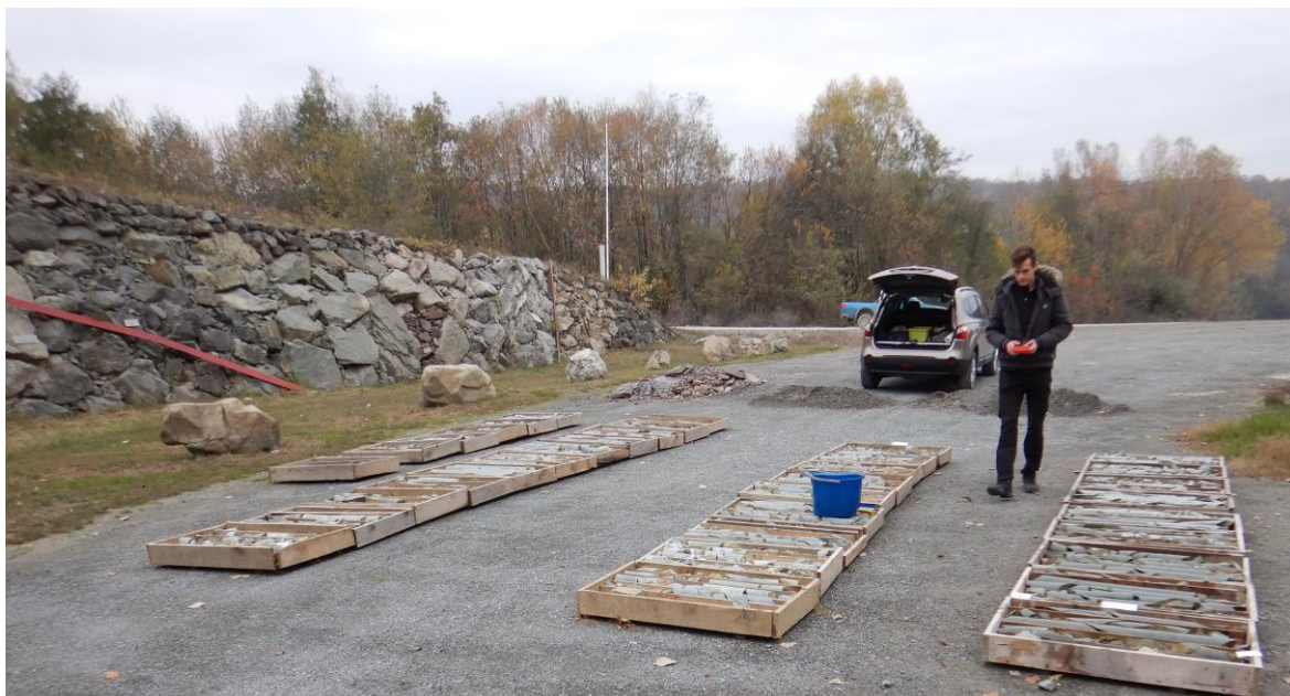
Slika 4-2 Izvedene istražne bušotine s jezgrovanjem oznaka B-1/21, B-2/21, B-3/21 i B-4/21
