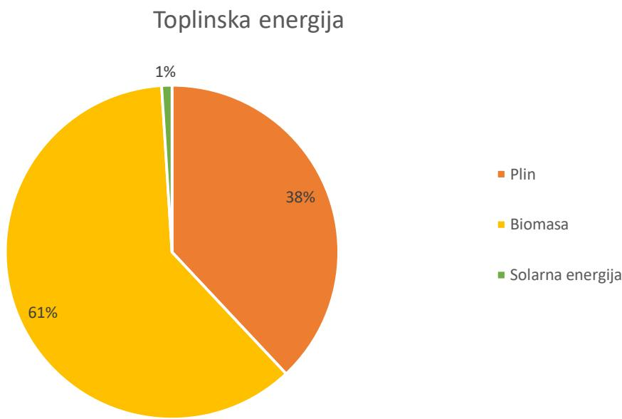
**Slika 2-3.** Omjer korištenih energetskih izvora za proizvodnju toplinske energije individualnog grijanja (EIHP, 2022)
