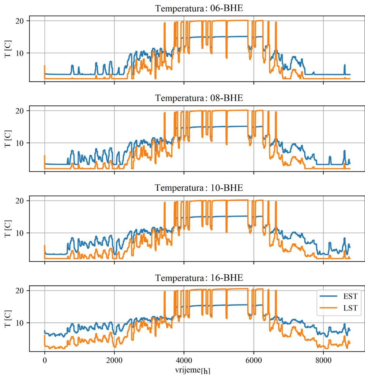
**Slika 8-12.** Uzlazne i izlazne temperature u bušotinskim izmjenjivačima topline
