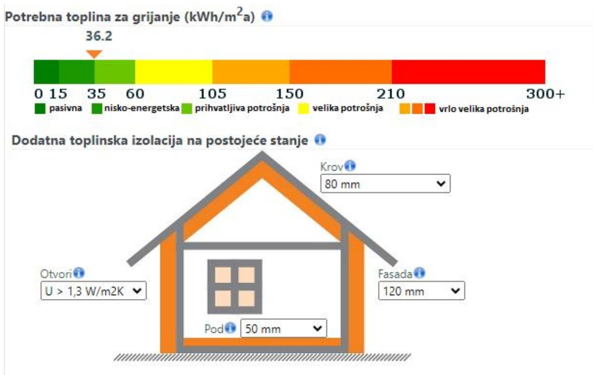
**Slika 8-1.** Potrebna toplina za grijanje izražena u kWh/m<sup>2</sup> (Knauf Insulation, 2023)
