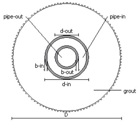
**Slika 8-3.** Podaci koaksijalnog tipa izmjenjivača topline
