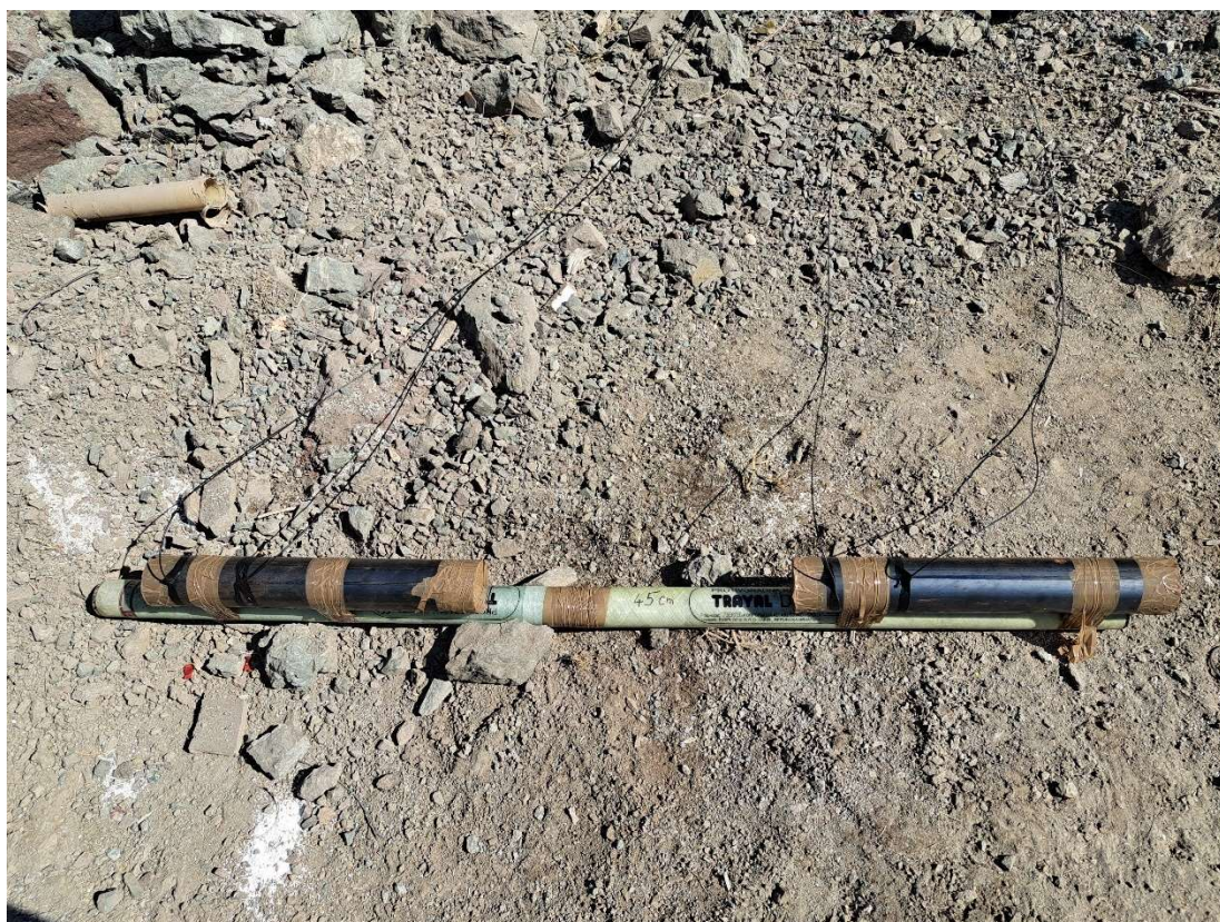
Slika 4-13. Ispitni uzorak postavljen za ispitivanje s razmakom patrona 45 cm
