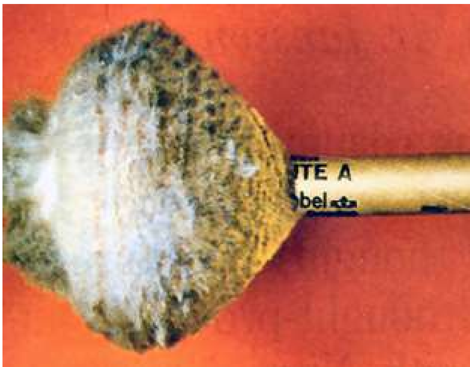
Slika 2-4. Patrona eksploziva pri detonaciji (Škrlec 2015)
