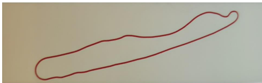
Slika 3-14. Dinamogram koji ukazuje na pojavu trenja u bušotini (Matanović i Moslavac, 2011)
