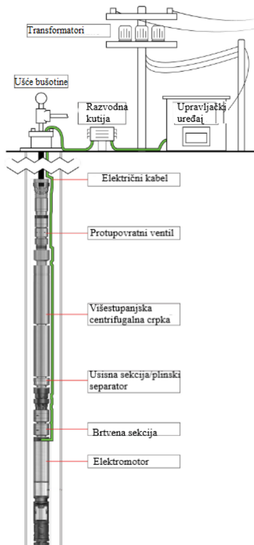
Slika 2-1. Proizvodni sustav s uronjivom centrifugalnom crpkom (Kimray, n.d.)
