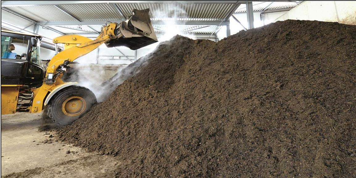
**Slika 4-19.** Digestat nakon anaerobne digestije (Hofmann, 2021.)
