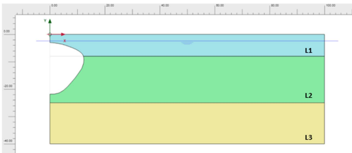
Slika 5-8. Oblik kaverne tijekom modeliranja u PLAXIS 2D
