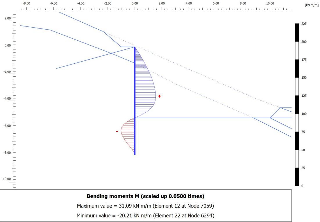
Slika 5-13. Anvelopa momenta savijanja pilota konstrukcije za slučaj C
