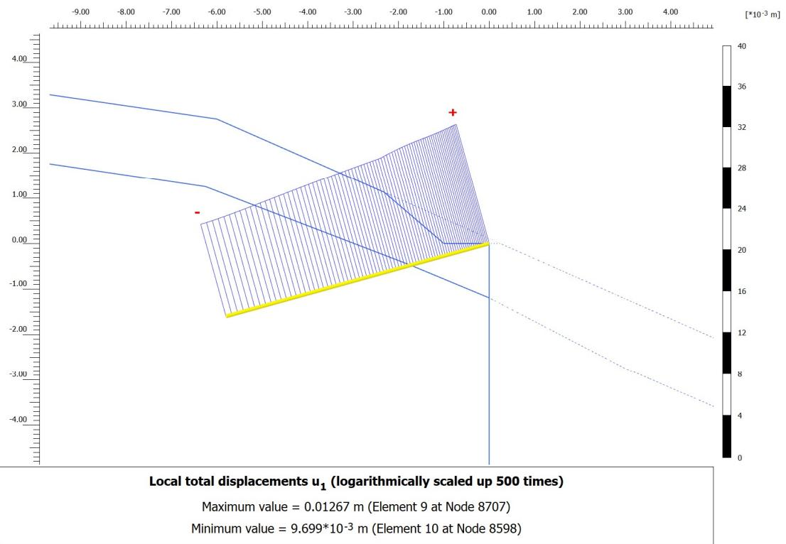
**Slika 5-16.** Uzdužni pomaci u štapnim sidrima zaštitne konstrukcije za slučaj C
