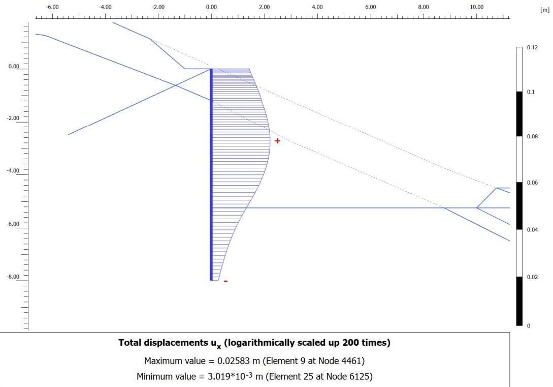
**Slika 5-9.** Horizontalni pomak pilota zaštitne konstrukcije za slučaj B
