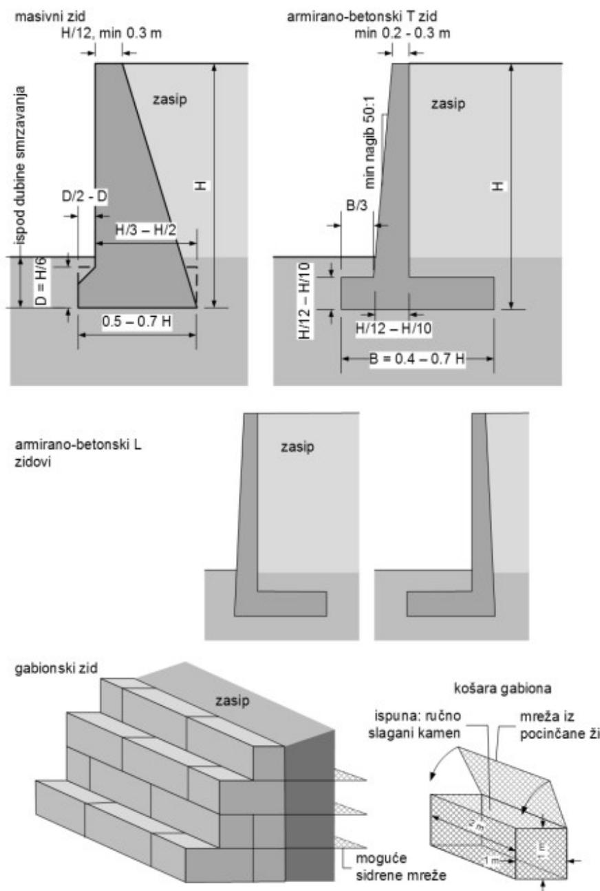
Slika 2-1. Vrste potpornih zidova s preliminarnim proračunskim dimenzijama (Szavits-Nossan, 2012)
