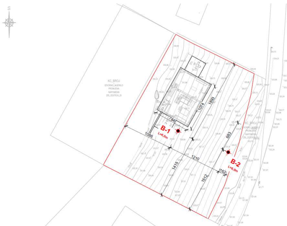
Slika 4-4. Pozicije istražnih bušotina u tlocrtu (Martomis projekt, 2022)
