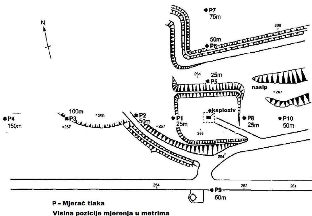
Slika 5-1. Plan poligona za testiranje (Formby i Wharton, 1996)
