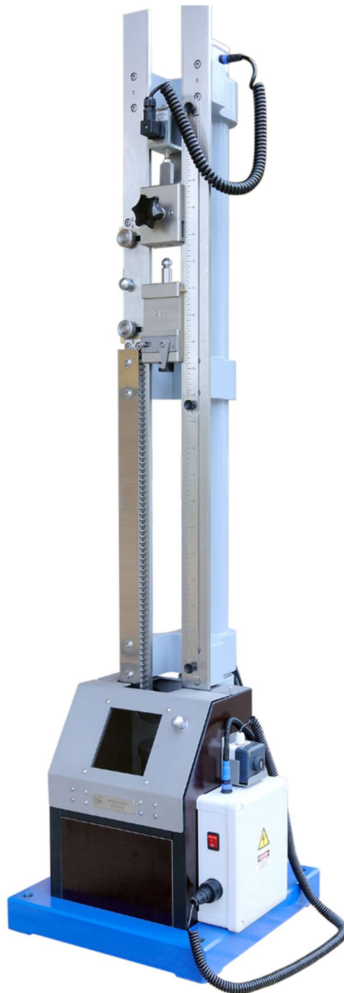
Slika 3-7. Uređaj za određivanje osjetljivosti eksploziva na udar (Mueller instruments, n. d.)
