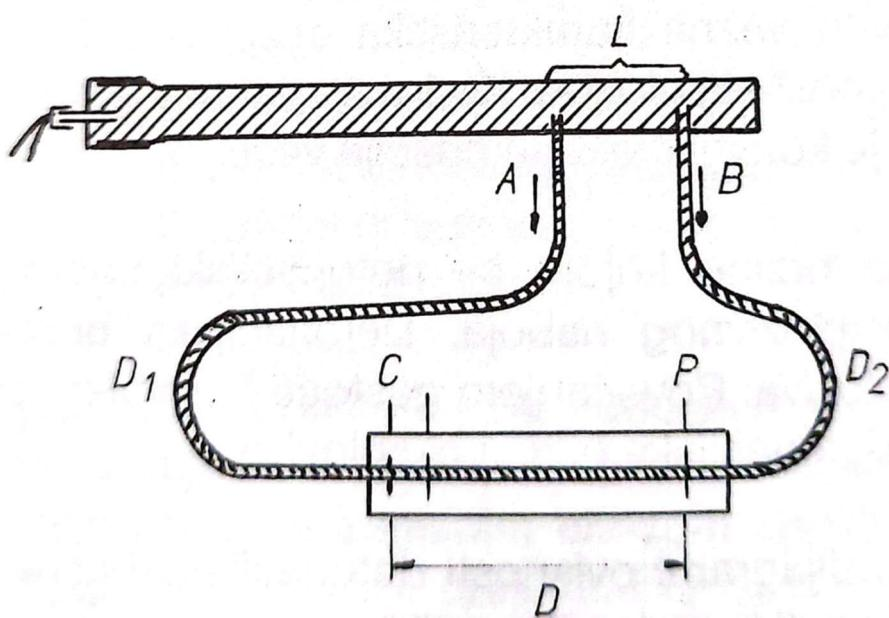
Slika 3-5. Mjerenje brzine detonacije po metodi Dautriche (Krsnik, 1989)
