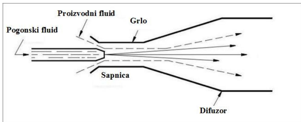
Slika 2-4. Dijelovi mlazne crpke (Khammassi, 2021)
