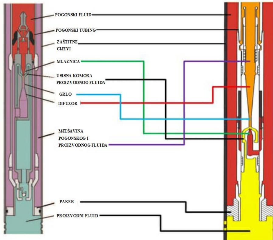
Slika 2-3. Shematski prikaz normalnog i reverznog toka kroz mlaznu crpku (Fetoui, 2017)
