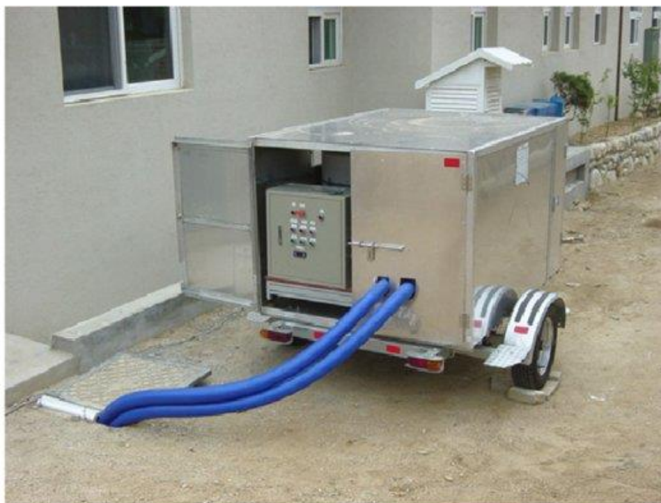
Slika 3-2. Površinska TRT jedinica (Lim, K. B. i sur., 2006)
