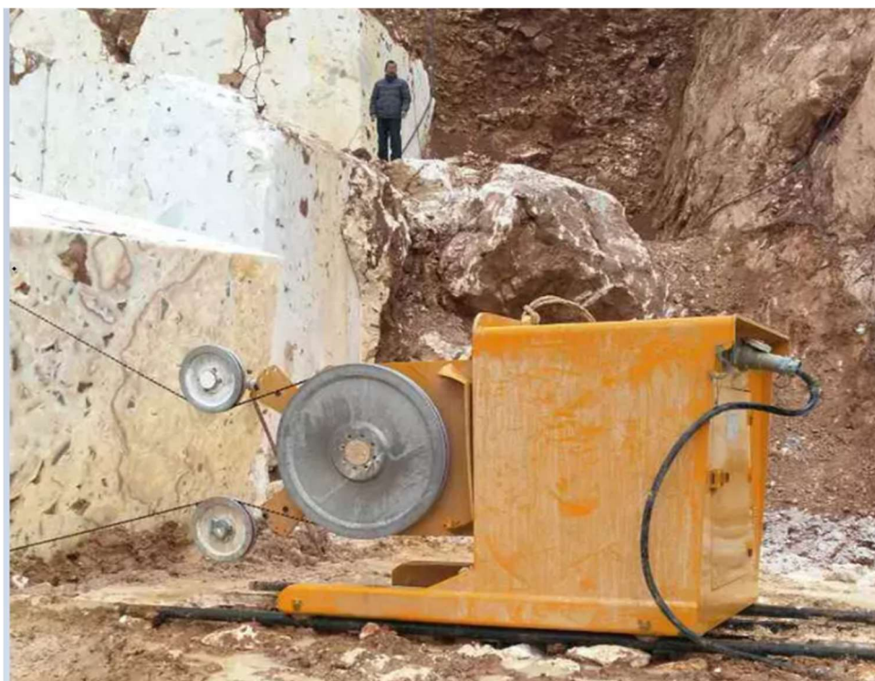
Slika 2-3. Dijamantna žična pila ( promidžbeni materijal tvrtke Xiamen Bestlink)
