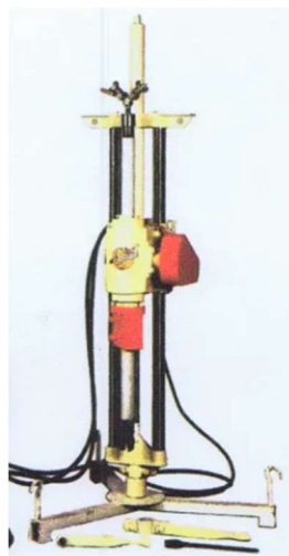
Slika 2-2. Hidraulična rotacijska bušilica (Michelletti machine)
