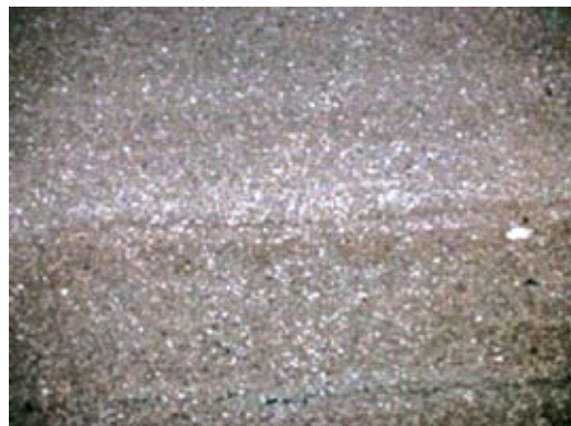
Sl. 5 i 6 Uzorak sa 3,0 m dubine: laminirana tekstura vidljiva (lijevo) i pod mikroskopom (desno)
