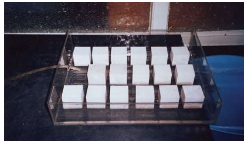
Sl. 2. Pripravci u posudi od pleksiglasa uronjeni u vodu do razine 3 \pm 1 mm
