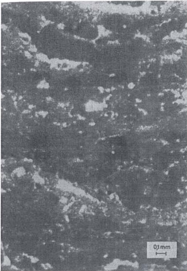
Sl. 3. Ranodijagenetski stromatolitski dolomit djelomično rekristaliziran (uzorak D 1 iz kompaktne zone)
