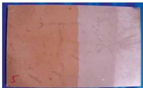
Uzorak 5 – Sivac po polovici premazan zaštitnim sredstvom
