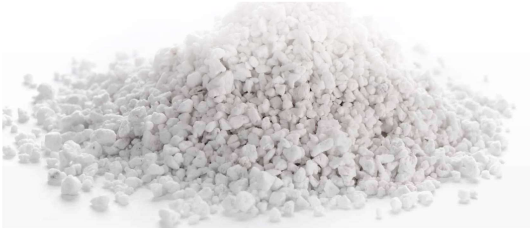
Slika 3-2 Ekspandirani perlit (Dicalite, 2024)
