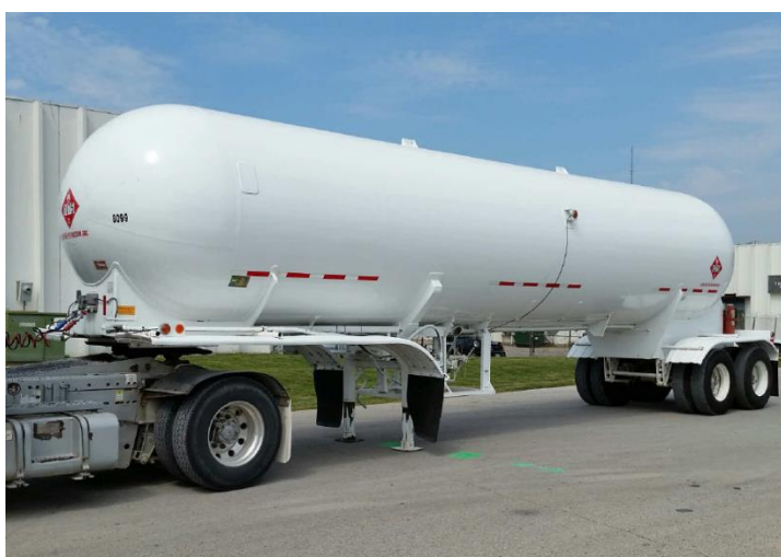
Slika 3-1. Kamionska poluprikolica sa spremnikom stlačenog plina (Center for Domestic Preparedness, 2022)
