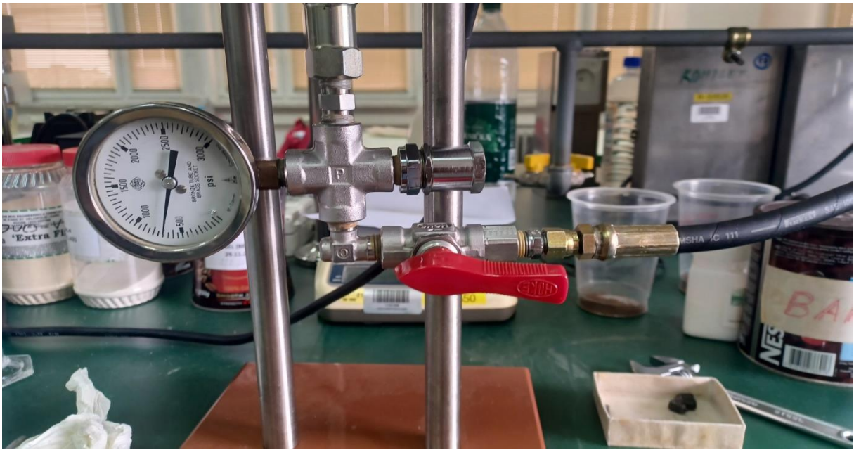
Slika 3-8. Manometar s prikazom, vrijednosti tlaka tijekom ispitivanja od 48,28 bar (700 psi)
