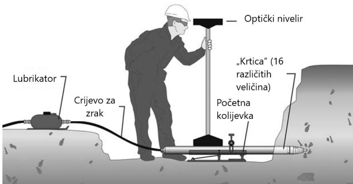
Slika 4-11. Prikaz rada „krtice“ (TT Technologies, 2013)
