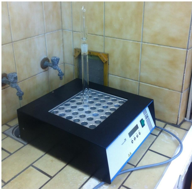
Slika 3-4. Digestor s „klopkom“
