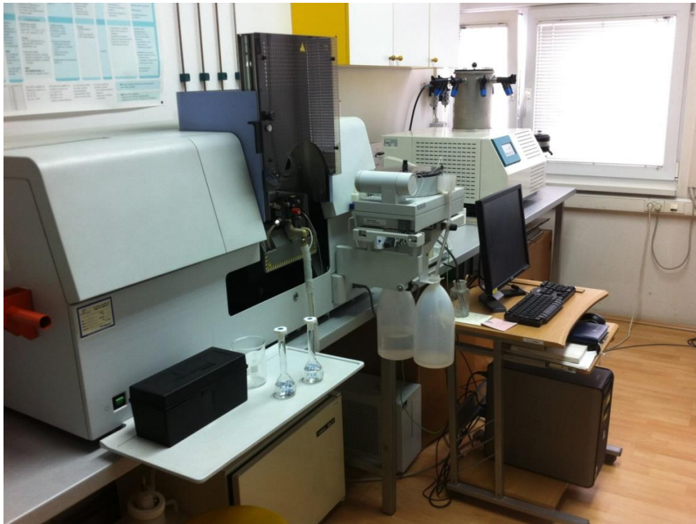
Slika 3-9. Atomski apsorpcijski spektrometar AAnalyst 700
