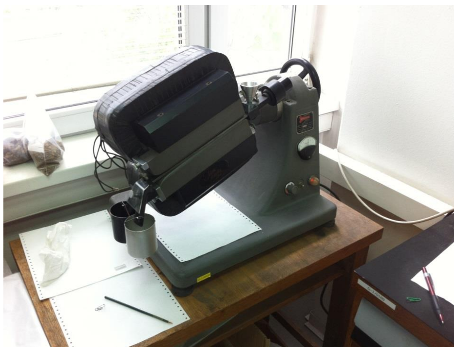
Slika 3-7. Izodinamički magnetski separator
