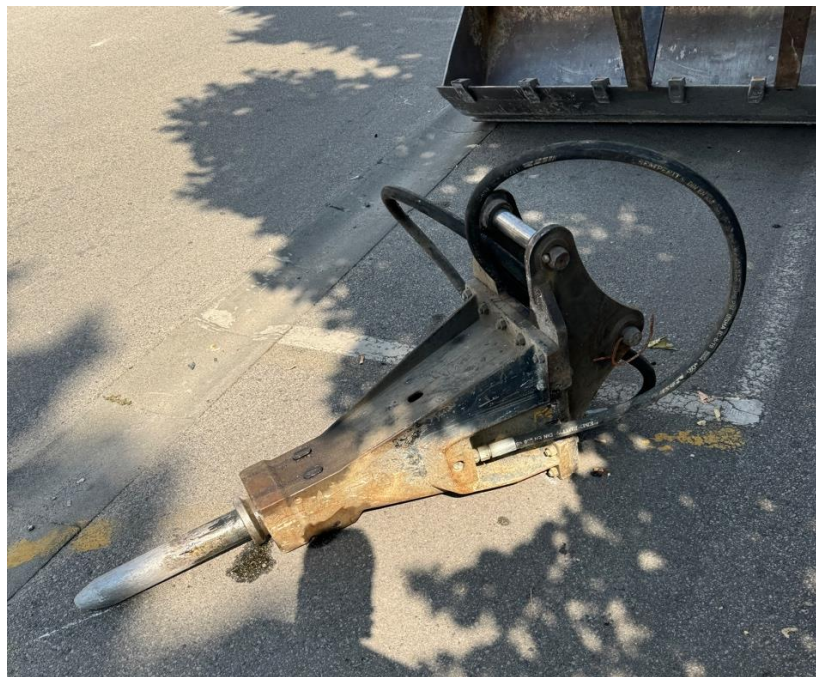
Slika 2-4. Hidraulični čekić manjih gabarita korišten u graditeljstvu i radni alat oštrog završetka
