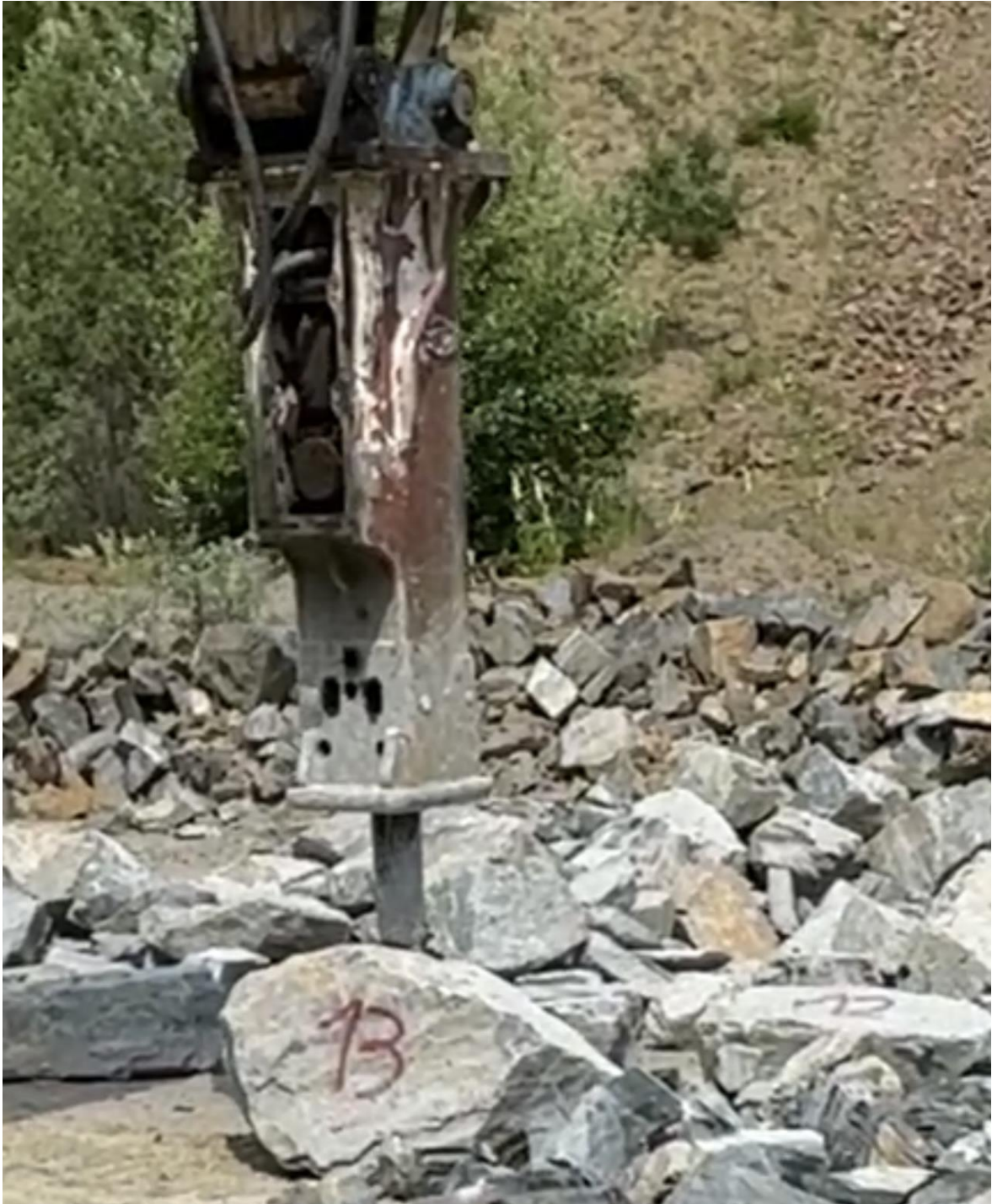
Slika 3-7. Pozicioniranje čekića prije usitnjavanja vangabaritnog bloka broj 13
