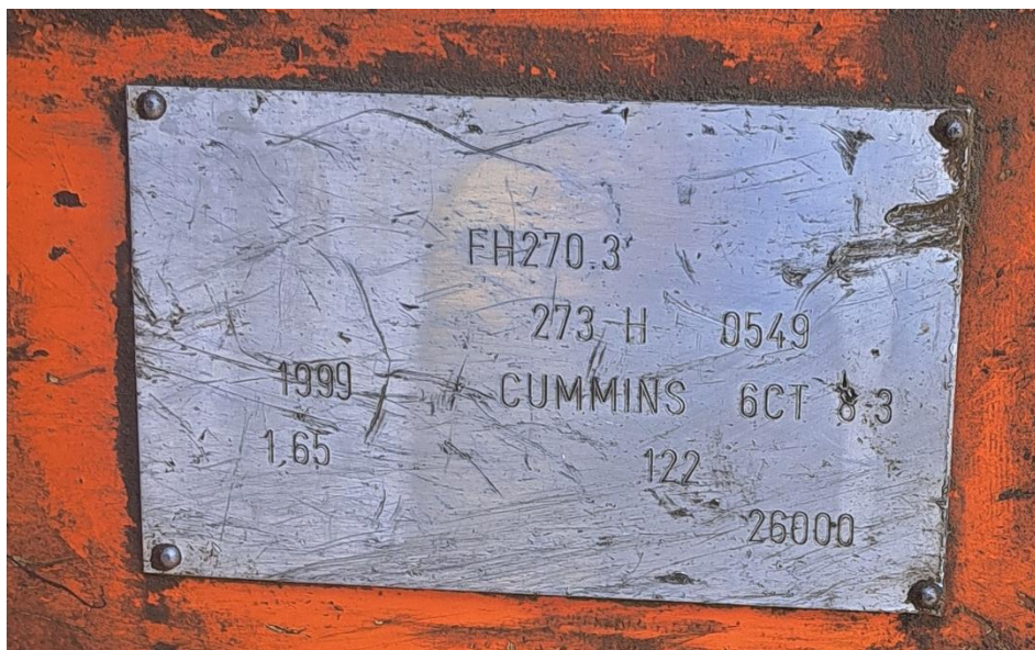
Slika 3-2, Bager Fiat FH270.3 specifikacijska pločica
