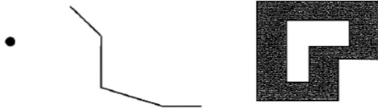
Slika 2-6. Temeljni geometrijski oblici: točka, linija i poligon (Galić, 2006)
